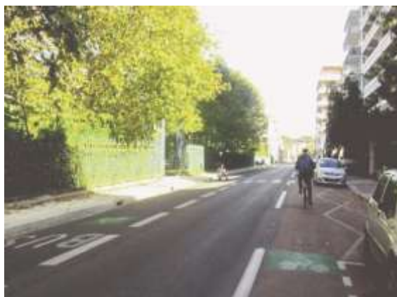
Barevný povrch odlišující směr vyhrazený pro cyklisty a parkovací místa
