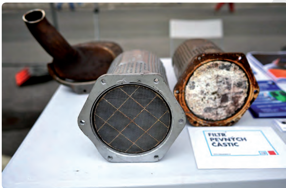
Na Dni pro Prahu jsme návštěvníkům předvedli zanesené filtry i levné a funkční čištění
