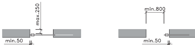
Obr. 144 Účinná světlá šířka posuvných dveří
