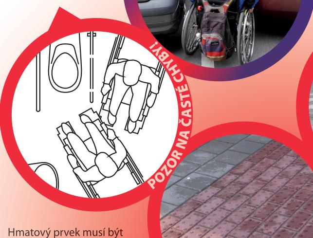
Hmatový prvek musí být pro uživatele rozpoznatelný – potřebný hmatový kontrast zajistit hladká rovná dlažba o rozdílech min. 20 x 20 cm. I sražené hrany jsou chybou!
